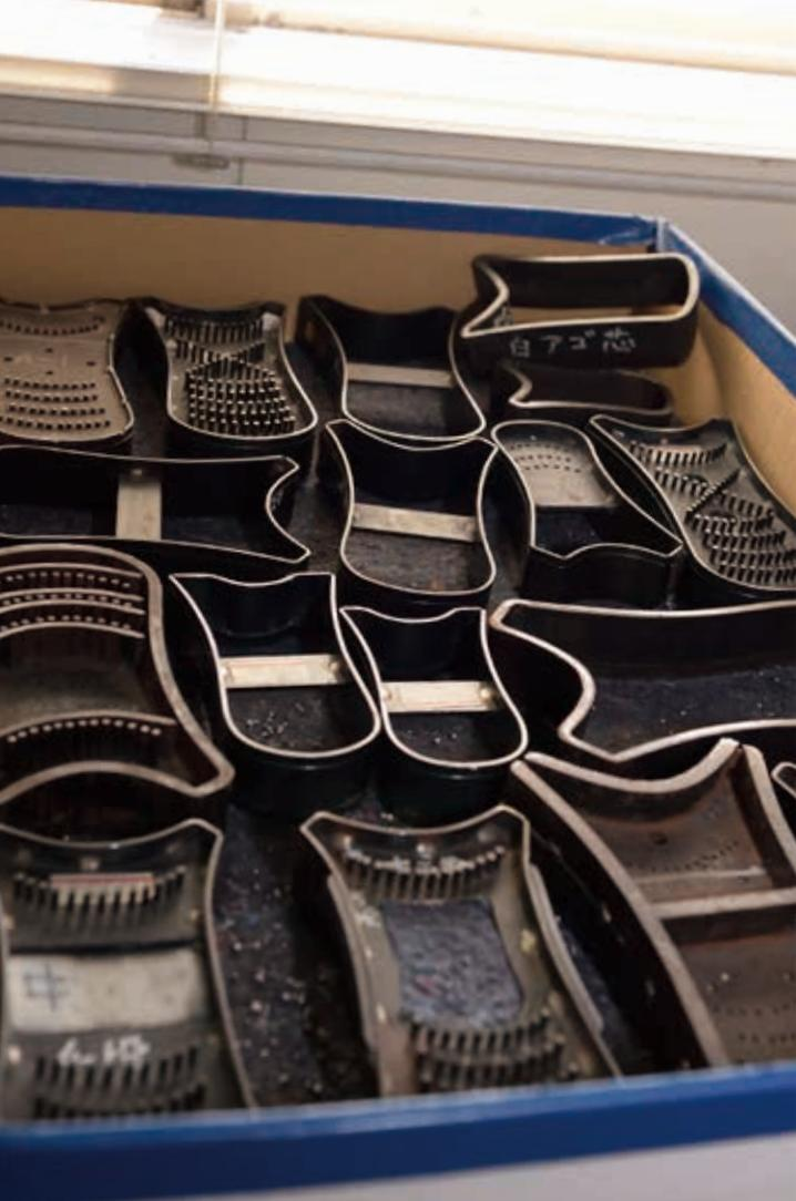
面の顎部分の金型。甲手や垂れなど、多くのパーツが型を使って製作されるが、各小売店用の型が日本剣道具製作所に多数保管されている
