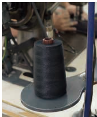
刺す糸も日本製。刺すときの熱や打突に耐えるものを、糸の業者と共同で開発した
