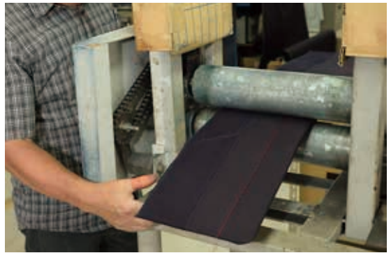
さらにローラーをくぐらせ、芯材の座り具合を整える
