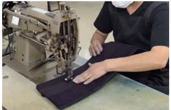
刺しを行なう前に、前号で芯材を詰めたる布団を、一箇所だけ縦に赤い糸で縫っておく
