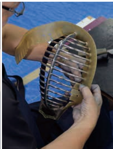
面の縁革にはあらかじめ穴を開け、やはり糸で縫い付けて固定する。 縫い付ける作業はかなりの力を要する
