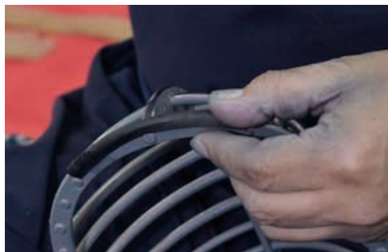
面金の天の部分にゴムを付ける。 長年つくり続けてきた中で生まれた工夫だという
