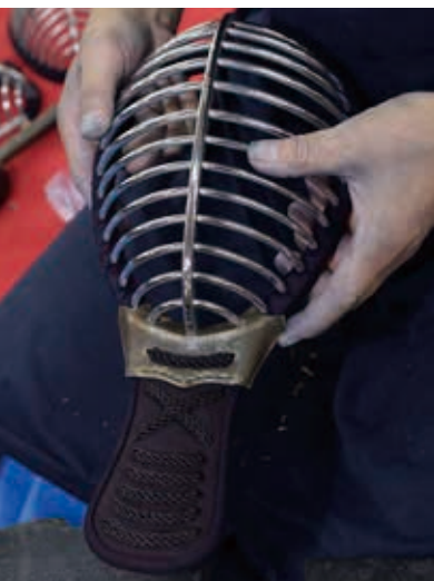
顎を面金に取り付けるには、生革を使い、縫い付けて固定する。 生革は水に4~5時間浸けて柔らかくなったところで作業をする
