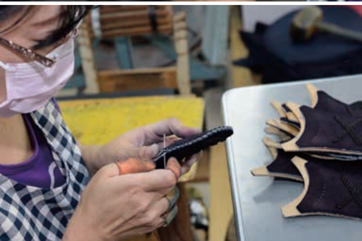
顎は飾りの入った表側と裏側の間に芯材を入れて貼り合わせ、周囲をまつり縫いしていく。このあとへりを付けるのも手作業である
