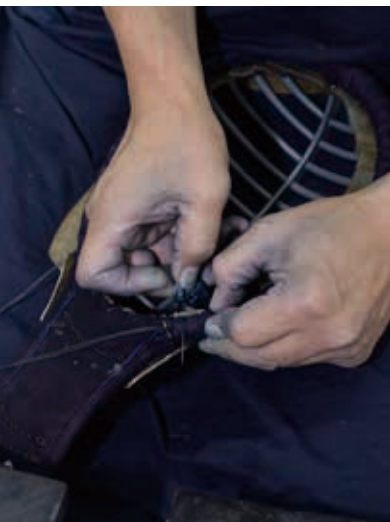
面の縁革にはあらかじめ穴を開け、やはり糸で縫い付けて固定する。 縫い付ける作業はかなりの力を要する
