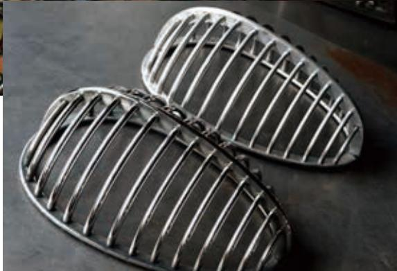
手前が鏡面研磨を施した面金で、奥が元の状態（写真はジュラルミン製面金）。同じ材質とは思えないほど光沢が出ている
