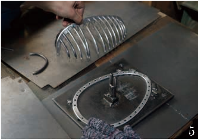
5 専用の台の上に固定して台輪と合体させる
