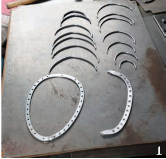
1 面金は14本を基準とする横ひご(上)、台輪(左下)、縦金(右下)を組み立ててつくる。ここからは手作業だ
