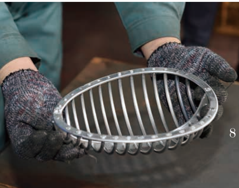
7 ハンマーで叩きながらかたちを整えるつつ、穴に横ひごを取めていく。この作業は長谷川さんが手を貸して仕上げを行なった
