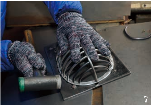
7 ハンマーで叩きながらかたちを整えるつつ、穴に横ひごを取めていく。この作業は長谷川さんが手を貸して仕上げを行なった
