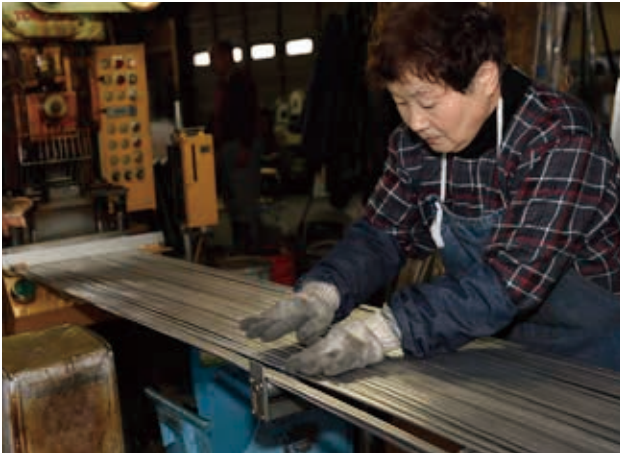
面金の横ひごとなるのは長い金属の棒。これをそれぞれ違う長さに切断していく
