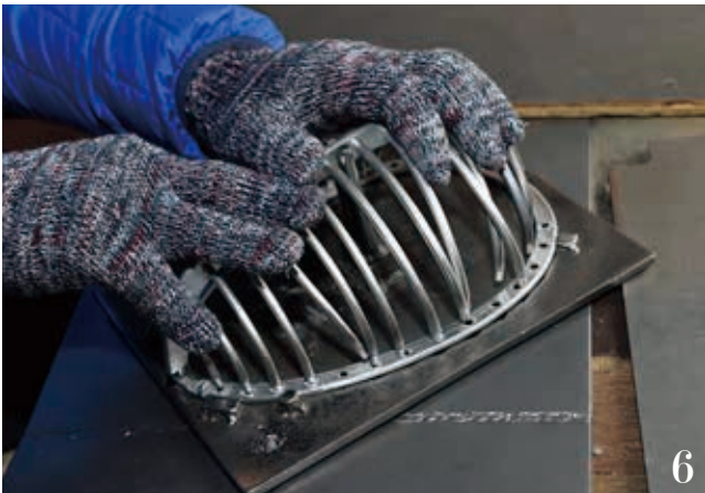
6 台輪に開けられた穴に一本ずつ差し込んでいく。すんなりとはいかない
