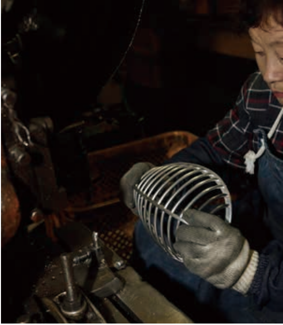
長谷川さんの母・優子さんが組み上がった面金を点検する。長年の経験から、長谷川さんが見逃してしまった歪みや曲がりまで見抜くそうだ
