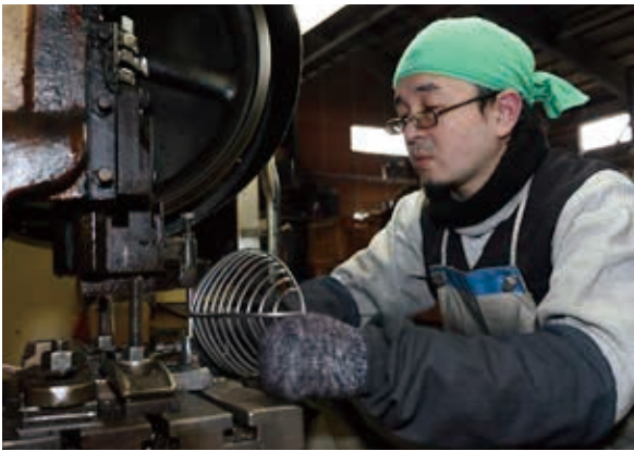
縦金と横ひごの接合部分もかきしめていく
