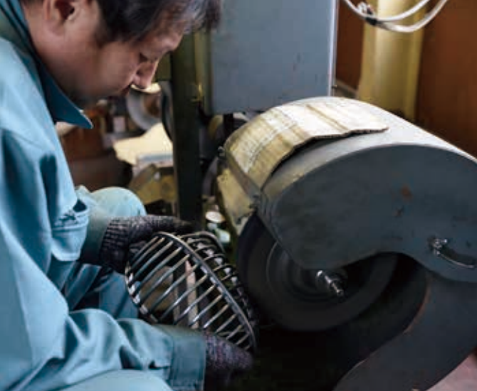
7月号で紹介した鏡面研磨の作業。 これは一つずつ手作業でやっていかなければできない
