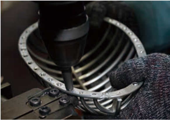
台座と横ひごの接合部分の一つずつかきしめる作業
